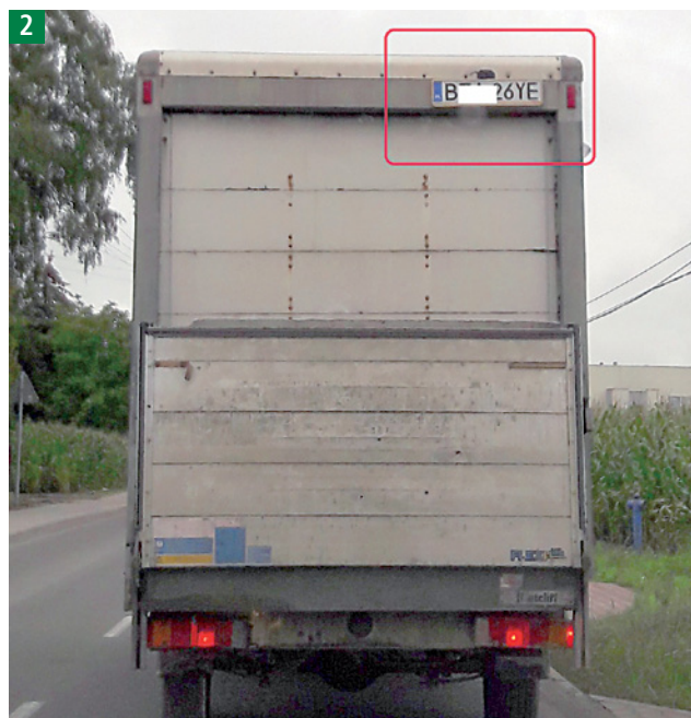
Przykład umieszczenia tablicy rejestracyjnej w miejscu konstrukcyjnym nieprzewidzianym przez producenta pojazdu. W dodatku zamontowana tablica znajduje się po niewłaściwej stronie pojazdu oraz na nieodpowiedniej wysokości
