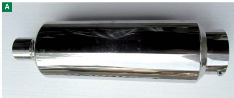
Wygląd zewnętrzny (A) i wewnątrz (B) nowoczesnego tłumika refleksyjno-absorpcyjnego o małych oporach przepływu
