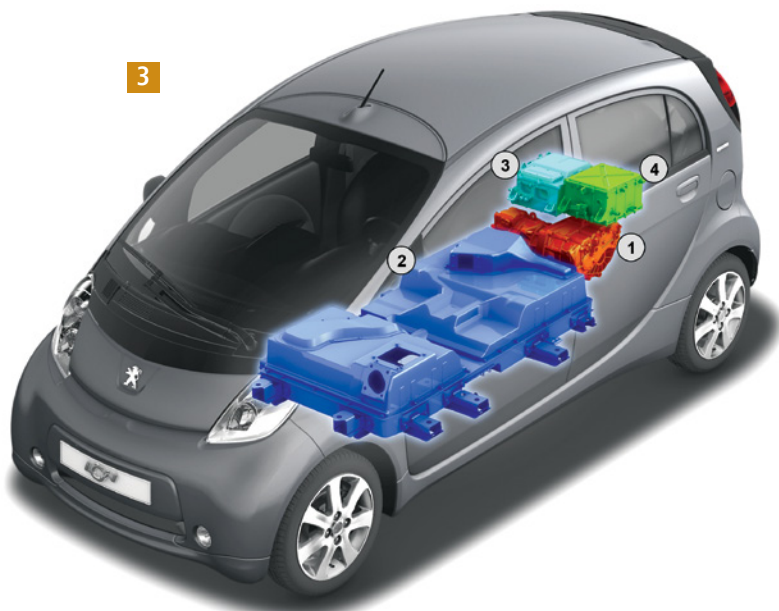
3 Zwarty zespół napędu elektrycznego umieszczono przed osią tylną: 1 – silnik elektryczny z reduktorem. 2 – akumulator trakcyjny. 3 – inwerter (falownik) silnika elektrycznego. 4 – ładowarka pokładowa OBC z przetwornicą DC-DC. Źródło: Stellantis
