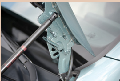
Numer 206, czyli siłownik maski z obecnej klasy C
