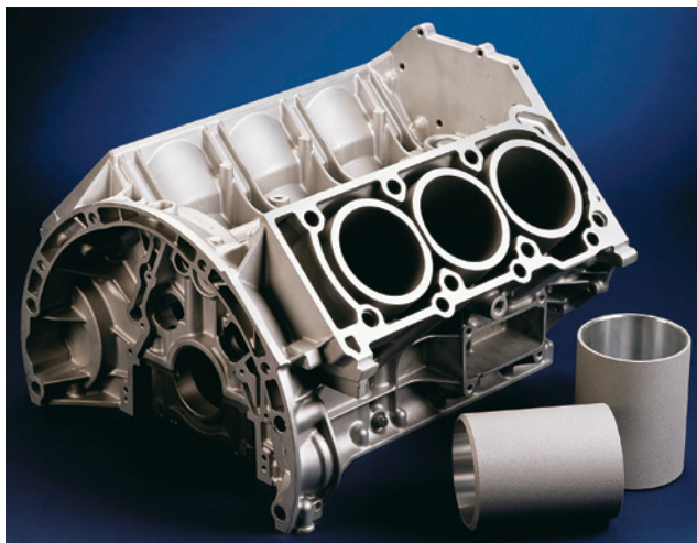
Otwarty kadłub silnika widlastego odlany wspólnie z górną częścią skrzyni korbowej (z linią podziału poniżej osi obrotu wału korbowego w celu zwiększenia sztywności); z prawej wstawiane tuleje cylindrowe
