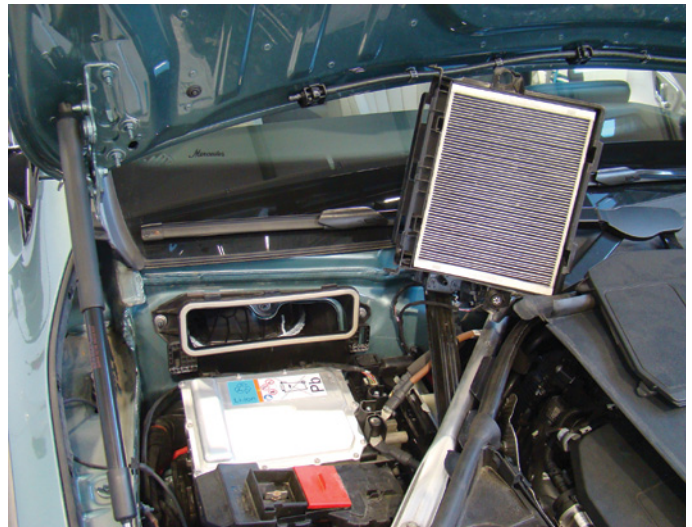
Od góry: wyjęty filtr kabinowy, bateria 48 V, plus (po odsunięciu czerwonej pokrywy)
