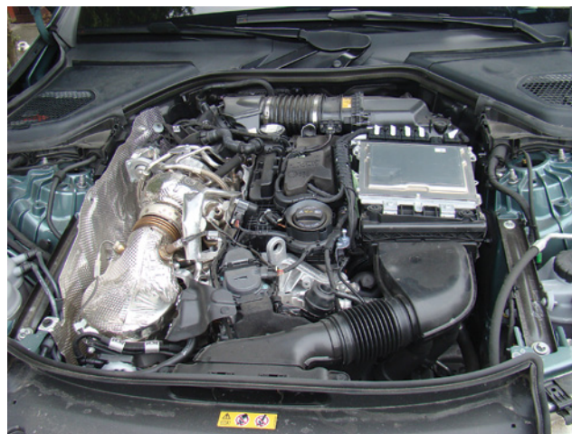
Po usunięciu środkowych osłon – wkład filtra oleju widać przy szerokiej rurze prowadzącej do filtra powietrza
