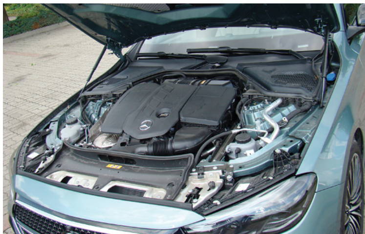
Pod maską, na górze są cztery, zdejmowane osłony. Wlew spryskiwacza, niebieski, przylutyl się do lewego błotnika
