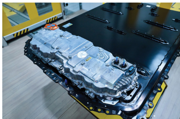
Bateria wysokonapięciowa 800 V z zamontowaną na niej centralną jednostką sterującą BMW Energy Master
