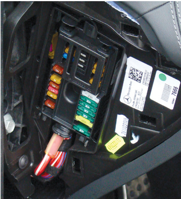
Bezpieczniki z boku deski rozdzielczej, trzeba uważać przy zakładaniu osłony tej skrzynki, żeby nie przynieść wypustek
