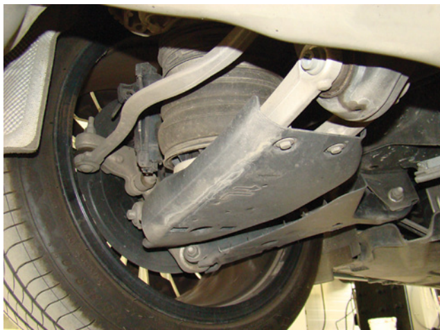
Z tyłu wahacze są obudowane od dołu, litera i strzałka wskazują na miejsce osłony. Sprężyny pneumatyczne (miechy), amortyzatory z regulacją tłumienia
