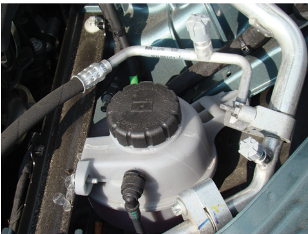
Lewa strona komory silnika – mniejszy zbiornik „wody” i dwa zawory do obsługi klimatyzacji
