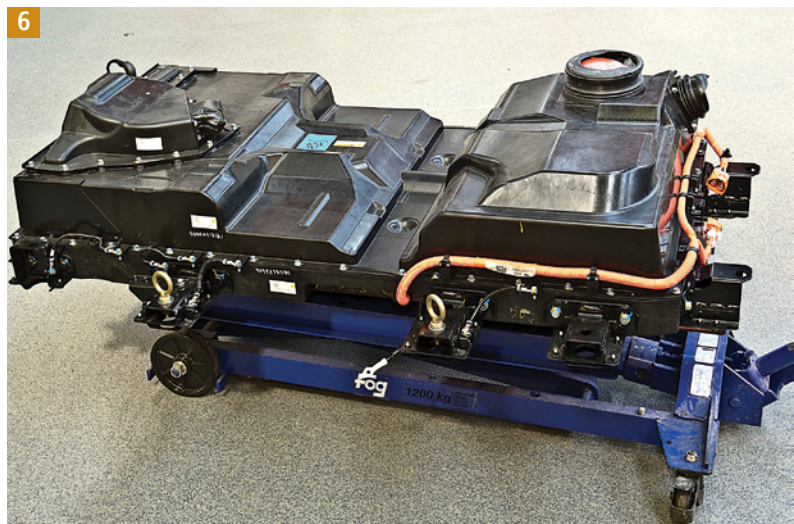
6 Zdemontowany zespół akumulatora trakcyjnego. Widoczny w części górnej kanał nadmuchu powietrza chłodzącego oraz pomarańczowe złącze zwory bezpieczeństwa. Coraz więcej producentów dopuszcza naprawę akumulatora trakcyjnego. Najczęściej operacje takie dotyczą wymiany ogniw czy uszkodzonego BMS
