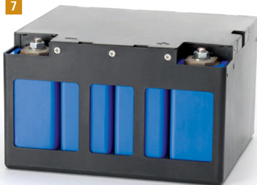
88 ogniw akumulatora trakcyjnego umieszczono w 12 modułach. 10 modułów gromadziło po 8 ogniw. Dwa pozostałe moduły gromadziły po 4 ogniwa. Na zdjęciu moduł z 4 ogniwami. Źródło: Mitsubishi
