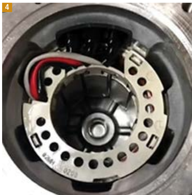
4 Stojan silnika elektrycznego sprężarki klimatyzacji jest chłodzony czynnikiem chłodniczym. Niewłaściwy olej sprężarkowy PAG może doprowadzić do utraty izolacji obwodu wysokiego napięcia na skutek przebicia do obudowy sprężarki. Źródło: Mitsubishi
