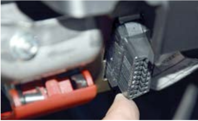
Gniazdo OBD pod lewym skrajem kokpitu, na wierzchu, niczego nie trzeba zdejmować
