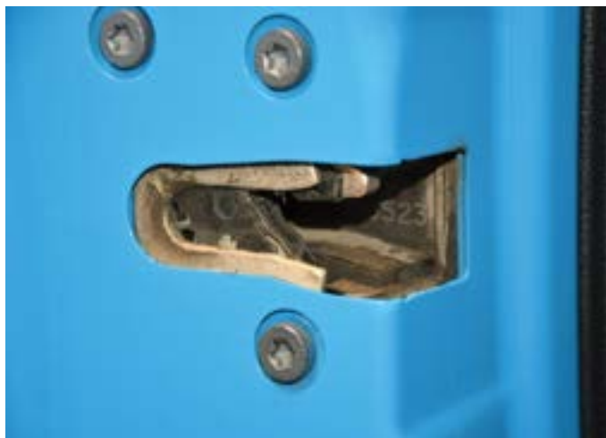
Stycznik jest w zamku w drzwiach kierowcy, jego zakrycie umożliwia wrzucenie luzu (N)
