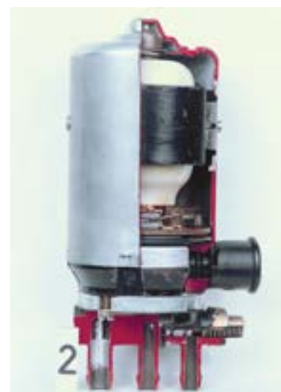
Stosowana w starszych rozwiązaniach silników zewnętrzna pompa paliwa
