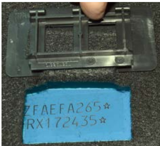
VIN na podłodze, przed fotelem pasażera
