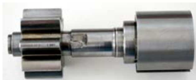
Pompa oleju i pompa podciśnienia z widocznymi uszkodzeniami
