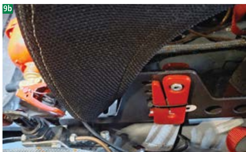
Dodatkowa zawlecza przy pasie bezpieczeństwa (a), obowiązkowy nóż do przecinania pasów bezpieczeństwa (b)
