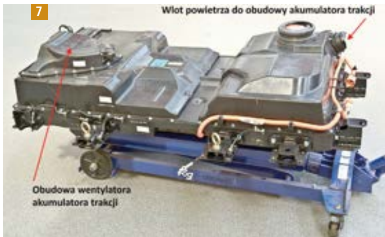
Zdemontowany akumulator trakcji z widocznymi elementami powietrznego obwodu chłodzenia
