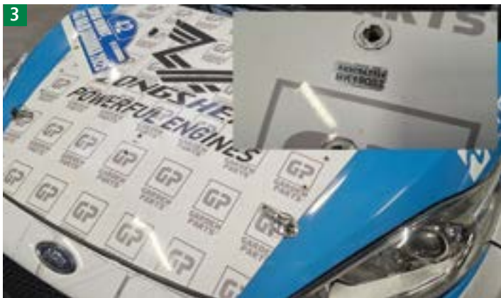
3 Hologram na elemencie nadwozia i dodatkowe zapięcia pokrywy silnika
