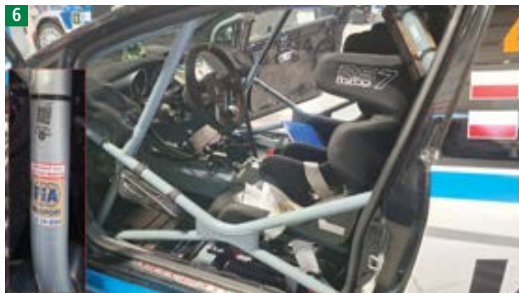
6 Klatka bezpieczeństwa i przykładowe oznakowanie homologacyjne klatki
