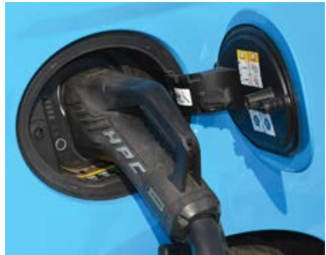
CCS jest na tylnym, prawym błotniku – trzeba pamiętać o jego lokalizacji podjeżdżając do ładowarki
