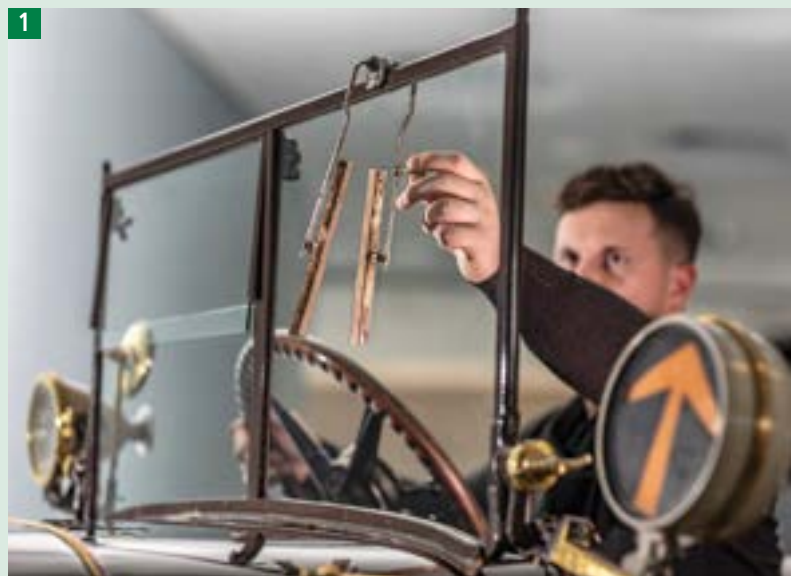
Pierwsza wycieraczka przedniej szyby opatentowana w 1903 r. przez Mary Anderson. Miała drewniane ramiona z przymocowanymi gumowymi listwami. Fot. Mercedes
