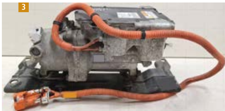
3 Zespół wysokonapięciowej sprężarki klimatyzacji Mitsubishi i-MiEV. Widoczna w części górnej obudowa falownika sterującego obrotami silnika synchronicznego z magnesami stałymi. Oczywiście sprężarka ma również (niewidoczne na zdjęciu) złącze instalacji 12 V z przewodami zasilającymi i sterującymi elektroniką inwertera. Źródło: commons.wikimedia.org
