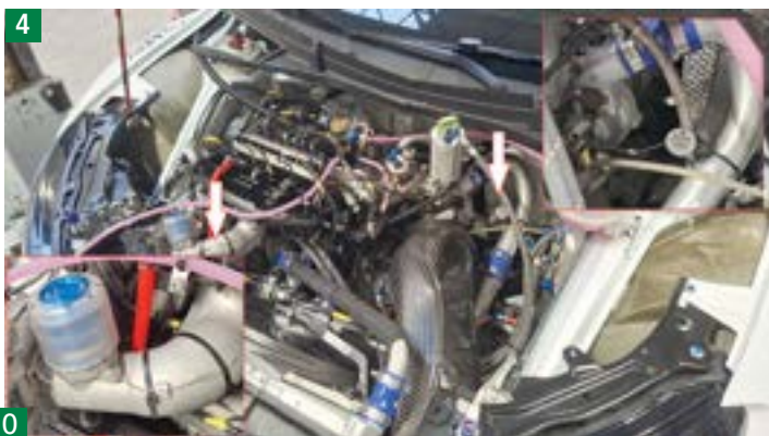
4 Plomby zabezpieczające elementy osprzętu silnika przed niedozwoloną manipulacją
