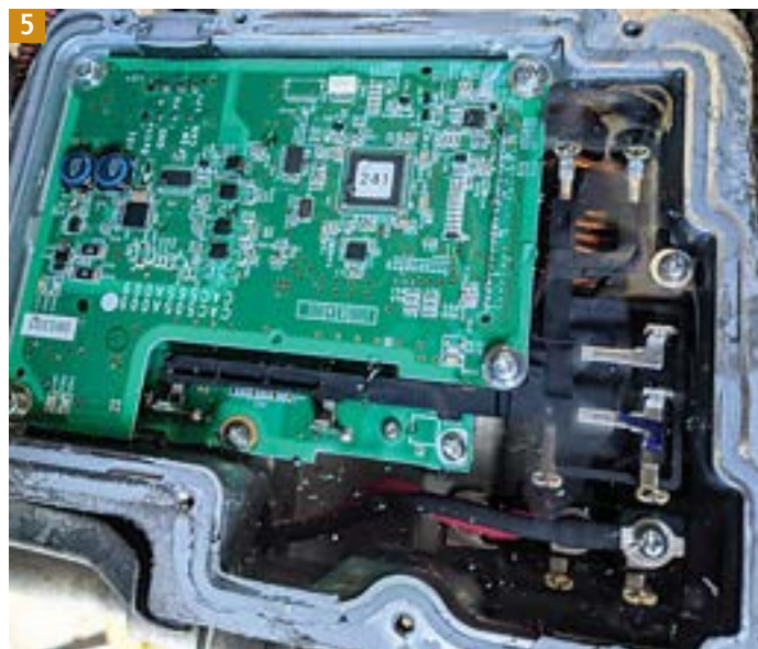
5 Płyta elektroniczna sprężarki klimatyzacji. Utrata szczelności obudowy bywa przyczyną przenikania wody do wnętrza po stronie sterowania. Co ciekawe, woda wewnątrz płyty może również prowadzić do występowania błędów typu P1A44 oraz P1A45. Mycie spodu auta z wykorzystaniem myjek wysokociśnieniowych zwiększa ryzyko ww. anomalii. Źródło: commons.wikimedia.org
