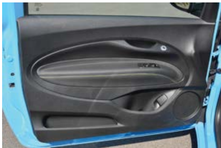
Dwa sposoby na otwarcie przednich drzwi: okrągły przycisk na górze i „dźwignia awaryjna” za głośnikiem
