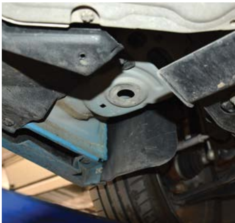
Miejsce do podstawienia łapy podnośnika (na zdjęciu z przodu auta) nie jest przy progu
