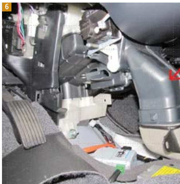
6 Przewód łączący zespół wentylacji wnętrza z kanałem doprowadzającym powietrze chłodzące do obudowy akumulatora trakcji
