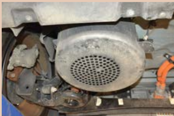
Wystarczy jeden głośnik, przy tylnym, lewym kole
