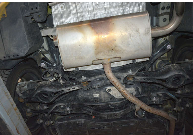
Widać od razu, gdzie uderzają gazy spalinowe. Filtr oleju na samym dole, trzeba zdjąć część osłony pod silnikiem mocowaną czterema śrubami
