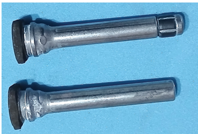
Komplet prowadników wymontowanych z zacisku. Górny prowadnik ma tulejkę stabilizującą
