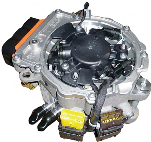
Pokrywa tylna alternatora odwracalnego. Widoczne konektory trzech czujników hallotronowych, złącza komunikacyjne oraz złącza obwodu chłodzenia
