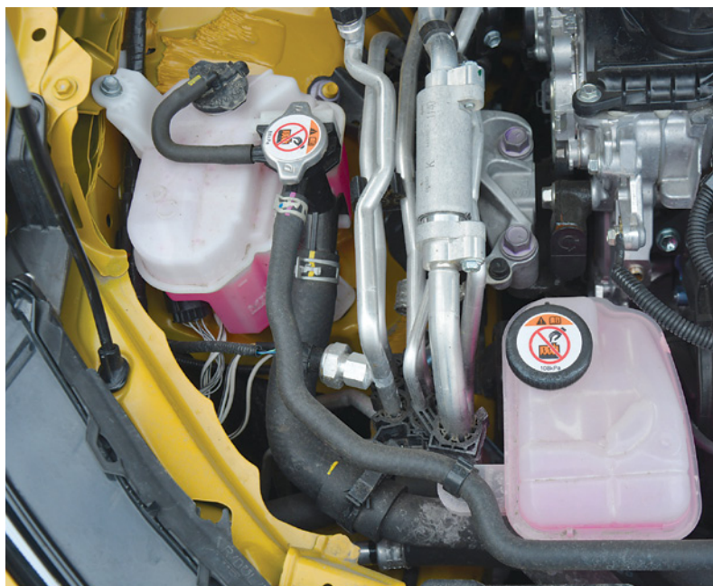
Dwa zbiorniki wyrównawcze układu chłodzenia, dalszy od silnika spalinowego, bliższy od układu sterowania mocą, czyli falownika
