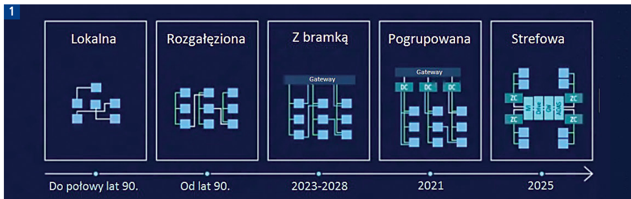
Ewolucja architektury sieci elektrycznej i elektronicznej w samochodach BMW: od lokalnej do strefowej
