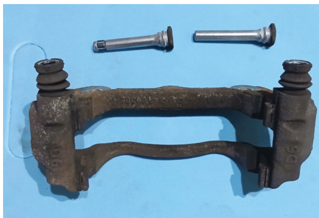
Jarzmo zacisku z wymontowanymi prowadnikami
