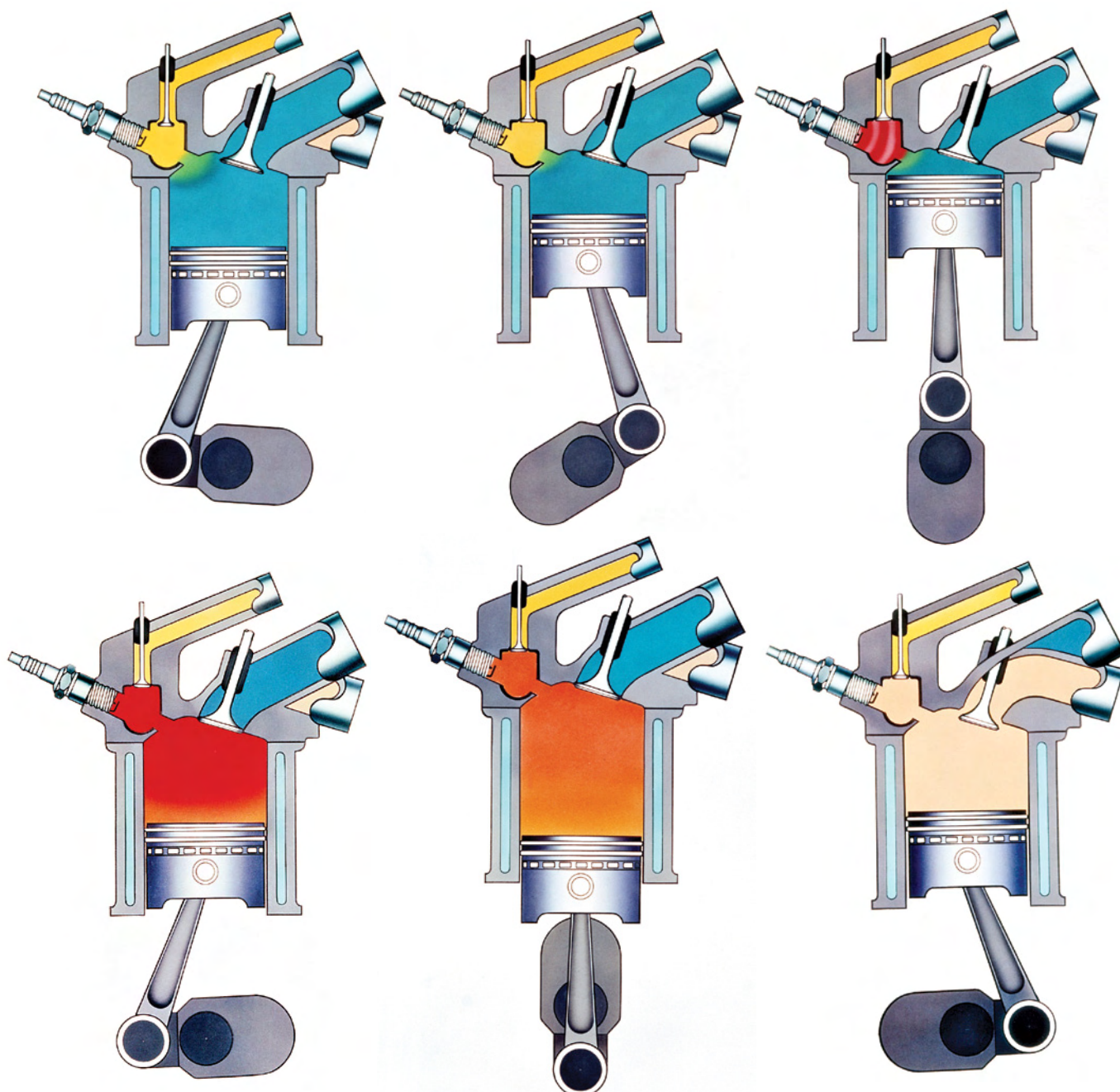
Działanie układu CVCC podczas kolejnych suwów pracy silnika
