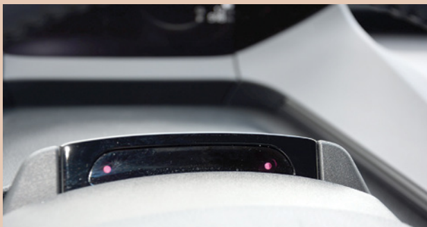
Kamera jest regulowana razem z kolumną kierownicy, w dwóch płaszczyznach
