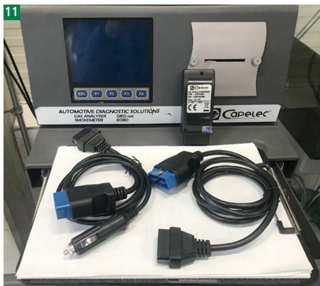
OBD Capelec w wersji 12 i 24 V jako przystawka do analizatora spalin
