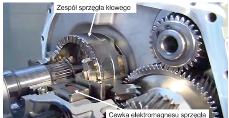
Przekrój sprzęgła kłowego wraz z cewką elektromagnesu sprzęgła. Jednym z symptomów awarii tego zespołu może być brak chwilowego podtrzymania ciągłości napędu podczas zmiany biegów. Źródło: GKN
