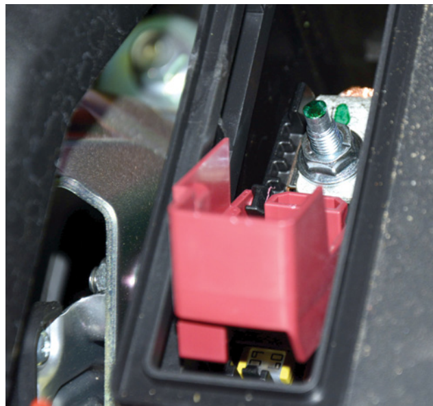
Plus przy skrzynce bezpieczników w komorze silnika. Akumulator 12 V jest na prawej ścianie bagażnika
