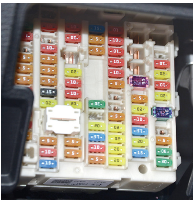
Bezpieczniki w kabinie; poniżej, pod kokpitem jest gniazdko OBD
