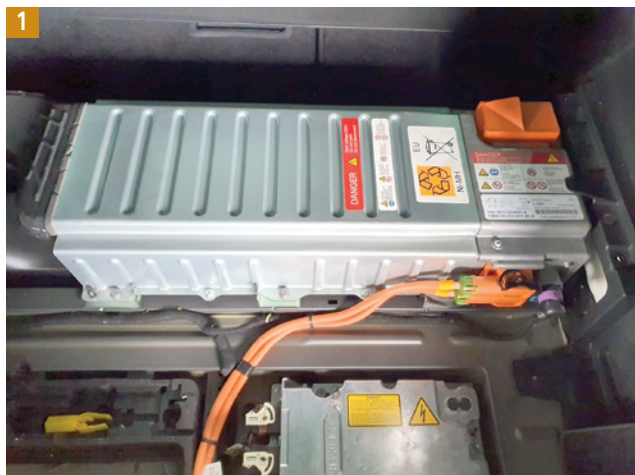
Akumulator niklovo-metalowo-wodorkowy (NiMH) firmy Sanyo. Widoczna pomarańczowa pokrywa zwory bezpieczeństwa
