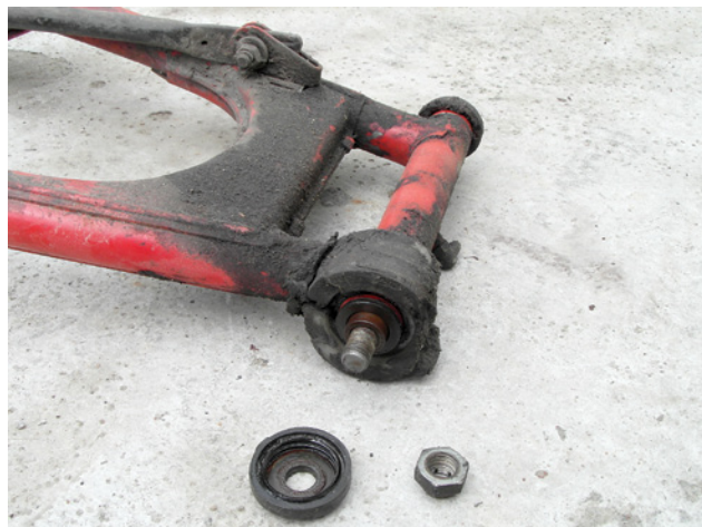
Wymontowany wahacz tylny łożyskowany na tulejach
