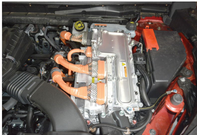
Przedni moduł rozdziału mocy Power Drive Unit (PDU) po wyjęciu osłony
