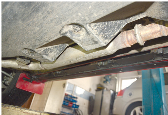
Układ wylotowy omija baterię z prawej strony
