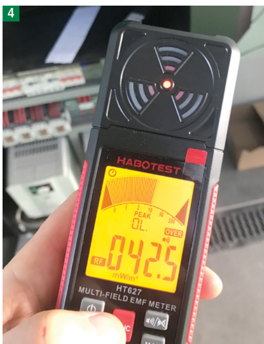
Fale radiowe w budynku SKP z siecią Wi-Fi
