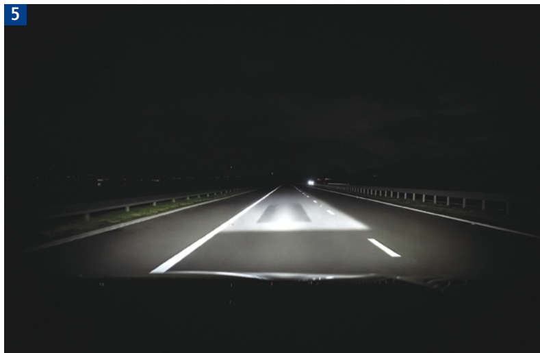
Działanie światła pasa ruchu z aktywnym oświetleniem orientacyjnym na autostradzie w nowym Audi Q3
