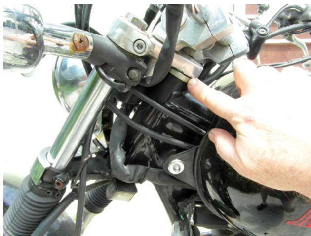
Tu ujawni się luz na łożyskach sterowych
